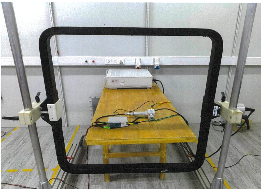
图 6: 工频磁场抗扰度检验配置图
